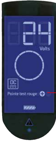
24 V DC algılama örneği, < 50 V olduğundan ekran MAVİ .
