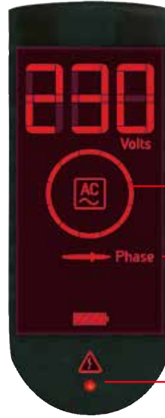
KIRMIZI renkte görüntülenen 230 V AC algılama örneği.
