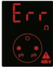
400 V altındaki fazlar arası bağlantı
